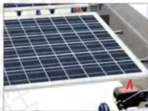
稳定检测基板位置
