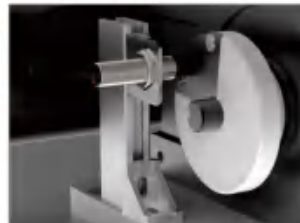
检测旋转机构原点位置
