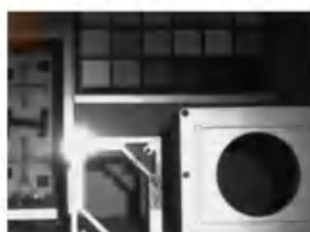
卷帘快门下, 图像发生拖影, 物体形变
